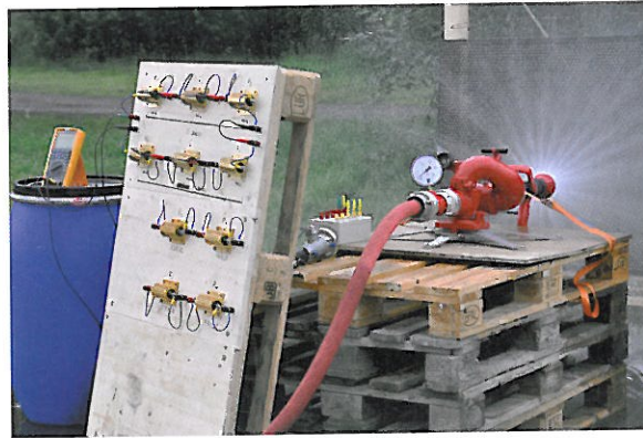
Bild 2 Versuchsaufbau: Elektrische Leitfähigkeit Strahlrohre.
