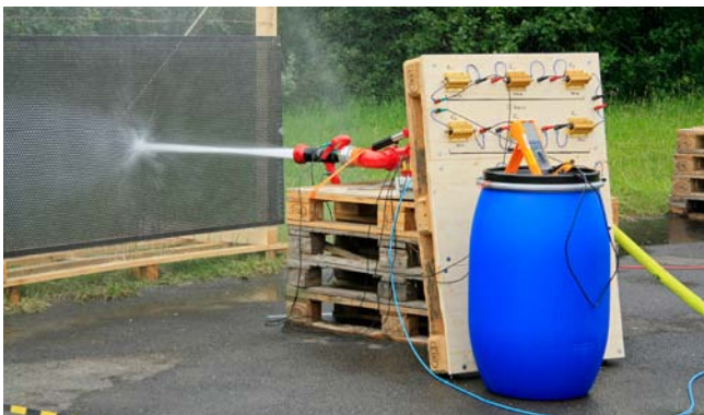
Messung der Leitfähigkeit des Wasserstrahls bei einem Meter Abstand
