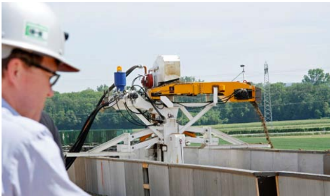
Versuchsanlage für den Pipe Express mit u-förmigem Grundgestell, welches mit verschiedenen Böden befüllt werden kann.
